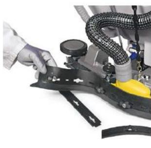
Le remplacement et la rotation des bavettes du suceur s'effectuent en quelques instants sans devoir utiliser d'outils
