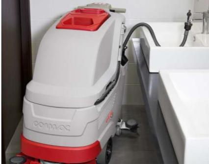
Le tuyau de remplissage du réservoir de solution peut être directement raccordé à n'importe quel type de robinet, ce qui offre la possibilité de se ravitailler partout et de rendre l'opération plus rapide
