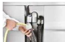
Pour un séchage toujours impeccable du sol, il est essentiel de nettoyer le tube du suceur à la fin de chaque cycle de travail. Cette opération permet au moteur d'aspiration de travailler dans des conditions optimales et d'en prolonger la durée de vie
