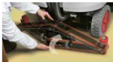
Ultra 85/100 B - Comac a conçu un système qui permet à l'opérateur de faire pivoter le suceur jusqu'à la position horizontale. De cette façon, les bavettes du suceur peuvent être parfaitement nettoyées et garantir en permanence un séchage optimal
