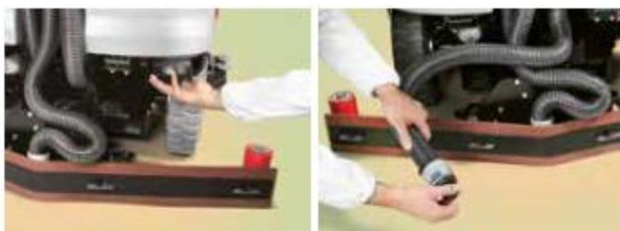
Nettoyage simple de l'ensemble du réservoir de récupération, grâce au grand diamètre de l'évacuation. Un tube de vidange supplémentaire peut être prévu pour atteindre les puits de collecte caractérisés difficilement accessibles par la machine
