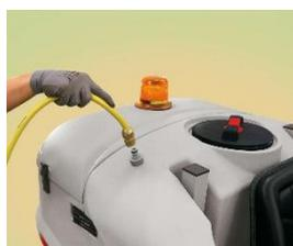
La présence du raccord à accouplement rapide avec flotteur de niveau permet de remplir le réservoir d'eau propre de manière simple et rapide (en option)
