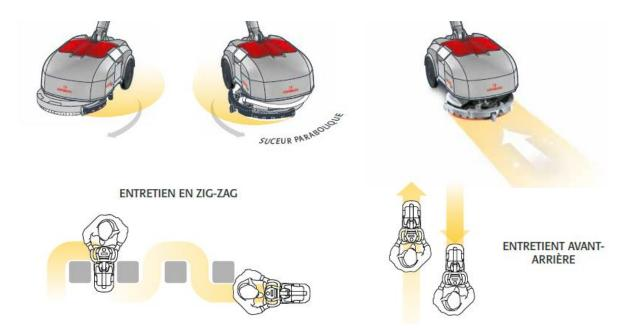
Le groupe brosse est déplacé latéralement par rapport au corps de la machine, ce qui permet de nettoyer parfaitement le long des murs et d'hygiéniser ainsi toute la surface utile de la pièce
